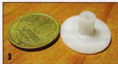
Шестерёнка после обработки под размер корпуса помпы.
