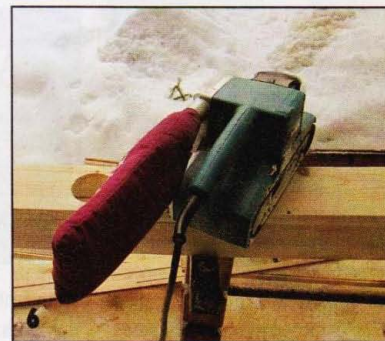
Тщательно обработали наружные поверхности короба ленточной шлифовальной машинкой.
