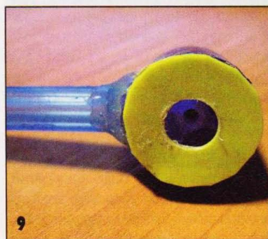
8 Из куска пластика вырезал крышку корпуса помпы с отверстием для подачи воды и приклеил её к корпусу помпы.
