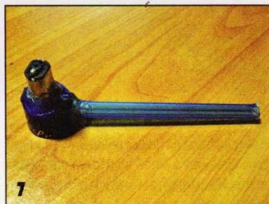
7 К корпусу помпы приклеил мотор и подающую трубку.
